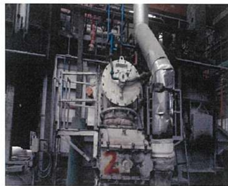
ภาพที่ 2 Two-Bed Regenerative Burner
